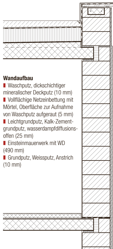
Schnitt durch die Aussenwand.
