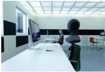
Figur 13: Hörversuch im Labor. Die Signale wurden den Probanden (im Hintergrund) über die im akustischen Labor eingebauten Lautsprecher vorgespielt und wurden von diesen bewertet. Quelle: Fraunhofer IBP
