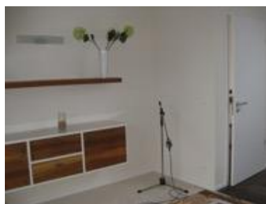
Figur 5: Eines von sechs Mikrophon bei einer Baumessung. Quelle: Fraunhofer IBP
