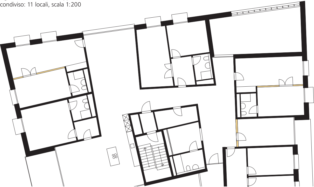
Fig. 17/Dimensioni dell'appartamento condiviso: 11 locali, scala 1:200
